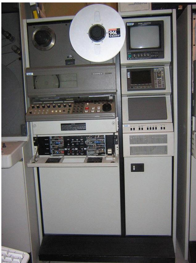
*Imagen 5. Magnetoscopio VPR 6 de Ampex. Fuente: <https://es.wikipedia.org/wiki/Magnetoscopio>*
